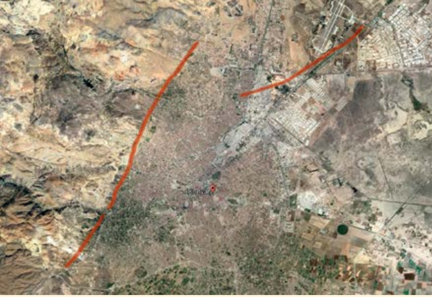
Şekil 4-Türkiye Diri Fay Haritasına göre Konya kent merkezi ve yakınından geçen diri faylar. Yerlerinin hassas olarak bilinmemesi nedeniyle faylar 100 m kalınlığında şeritler olarak gösterilmiştir. Yapılacak araştırmalar ile fay yerlerinin ve tarihsel dönem aktivitelerinin hassas olarak belirlenmesi gerekmektedir.
